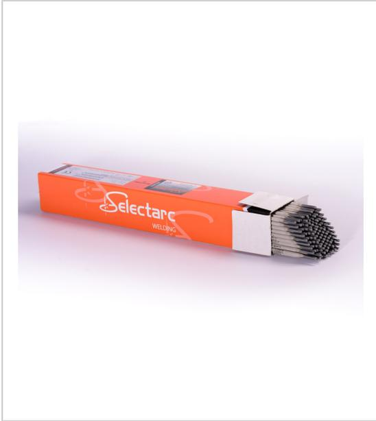
Électrode basique universelle (rendement 115%) offrant une grande sécurité pour tout assemblage fortement sollicité ou bridé excellentes résiliences jusqu'à -50°C, bonne résistance à la fissuration à froid, laitier facile à enlever pour châssis, charpentes lourdes, constructions navales, appareils à pression polarité : DC (+)
