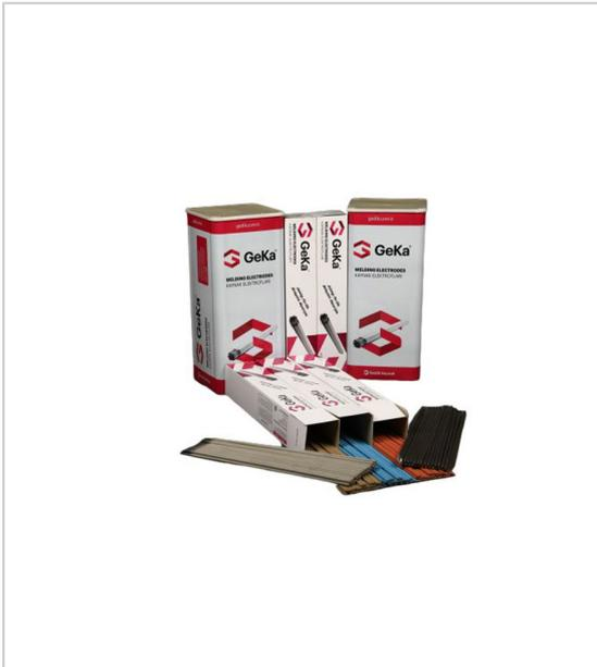
Electrode basique universelle (rendement à 110%) pour l'assemblage des aciers non alliés et faiblement alliés fortement sollicités ou bridés bonne résistance à la fissuration à froid, laitier facile à enlever positions de soudage : toutes, sauf verticale descendante polarité : DC (+).
