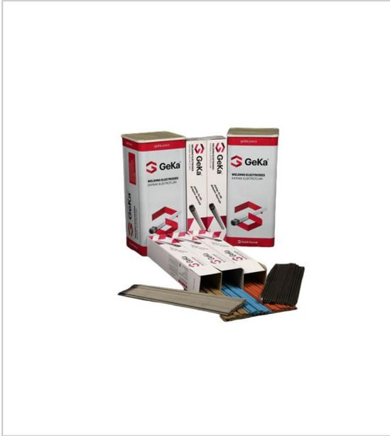
Électrode rutile à basse teneur en carbone pour le soudage des inox austénitiques non stabilisés de type 18/8/3 résistance à la corrosion générale et inter granulaire (jusqu'à 400'baC) position de soudage : toutes sauf verticale descendante polarité : DC (+) AC l'étui de 1kilo est en plastique transparent.
