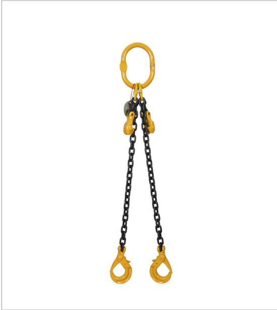
Acier haute résistance grade 80 crochet à verrouillage automatique griffe de raccourcissement pour ajuster la longueur des brins maille de tête soudée coefficient de sécurité 4/1.
