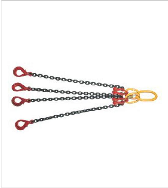
Acier haute résistance grade 80 crochets à verrouillage automatique griffe de raccourcissement pour ajuster la longueur des brins maille de tête soudée coefficient de sécurité 4/1.
