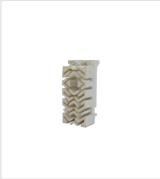
Embout lamellé à fixer en fond de feuillure au niveau du seuil de porte pour empêcher et limiter les remontées d'air et de vent dans le feuillure de la menuiserie.
