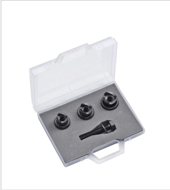
Emporte-pièces à tôles en acier carbone brunis permet de découper des trous sans bavure et non déformés dans des matériaux tels que l'aluminium, tube isolant, laiton et aciers doux jusqu'à 2 mm d'épaisseur. Sélection spéciale pour électriciens. Composition : vis sans butée à bille + Ø20,4-22,5-25,5mm.
