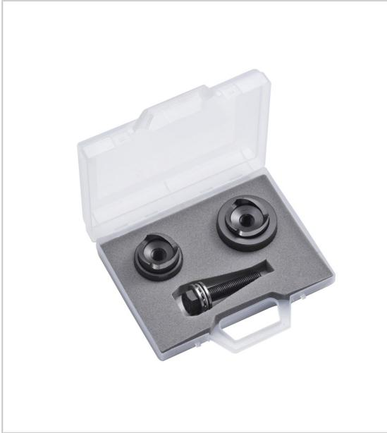
Emporte-pièces à tôles en acier carbone brunis permet de découper des trous sans bavure et non déformés dans des matériaux tels que l'aluminium, tube isolant, laiton et aciers doux jusqu'à 2 mm d'épaisseur. Sélection spéciale pour plombier : vis sans butée à bille + Ø32,5-35mm.
