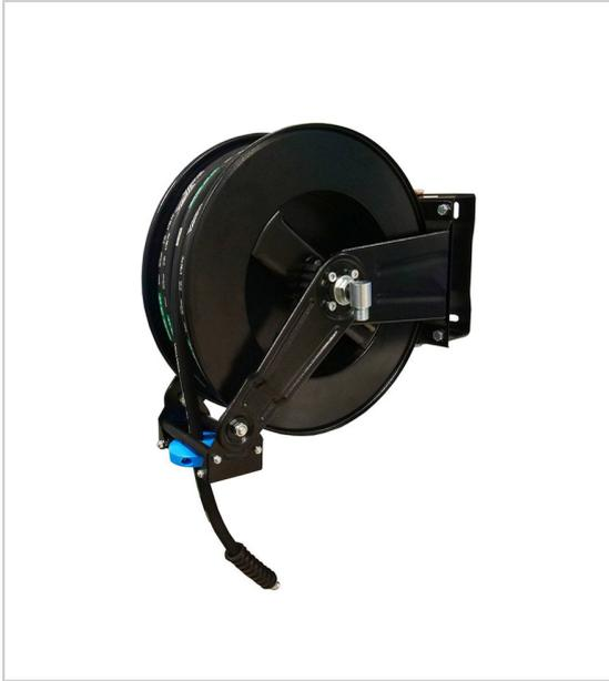
Système d'arrêt automatique : permet de bloquer le flexible à la dimension désirée, ressort enrouleur automatique à force constante complètement protégé, bras réglable afin de favoriser la sortie du flexible en fonction de l'installation de l'enrouleur, rouleaux de guidage flexible auto-lubrifiants, tampon bloque flexible réglable, flexible semi rigide renforcé 2 tresses métalliques.
