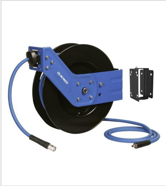
Pression nominale : 12 bar carter en acier avec revêtement époxy manchette de protection du sertissage butée de fin de course réglable support orientable à 180 ° tuyau de raccordement de 2 m rappel automatique par simple traction raccords gros débit tuyau Lacm'Flex, grande souplesse et haute résistance livré avec son support et 4 vis de fixation.
