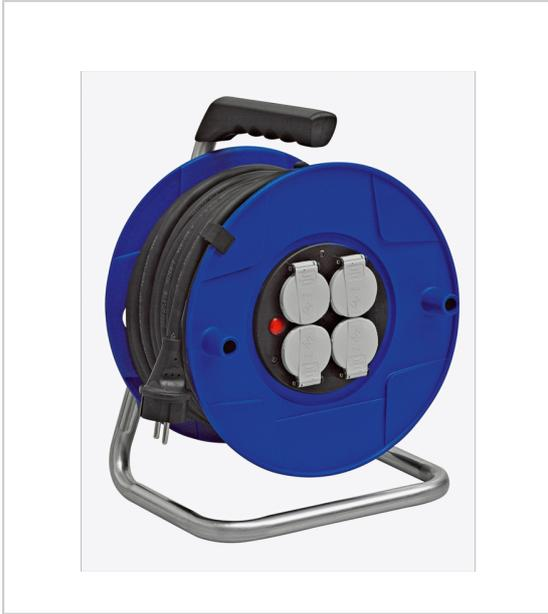
4 prises 2 P+T 16 A/230 V à clapets automatiques protections : IP 44 et disjoncteur thermique puissance maxi : câble déroulé :3500 W câble non déroulé :1000 W protection enfants tambour monobloc moulé en matière très résistante support en acier galvanisé poignée de transport moulée aux formes ergonomiques.
