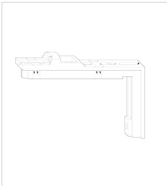
Equerre de compas pour OF/semi-fixe, système NT & NX, partie ouvrant.
