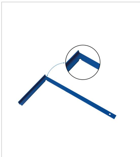
Equerre de maçon est un outil en acier plat permettant de donner de manière fiable des angles droits rebord permet le maintien en ayant les mains libres longueur : 60 cm largeur : 30 cm hauteur : 3 cm poids : 1,350 Kg.
