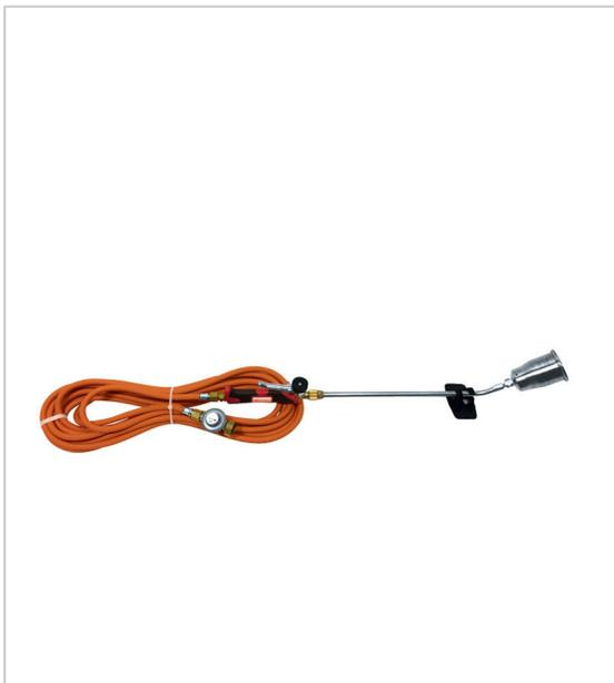
Pack chalumeau étanchéité polyvalent utilisation : séchage, chauffe de marquage, déneigement, désinfection, désherbage thermique consommation : 7394 g/h longueur de flamme : 800 composition : - godet ref. 100S, diamètre 60 mm - col ref. L400 - manche à gachette à sortie 3/8ème gauche ref. 650 - tuyau de 10 mètres ref. 963/10 - détendeur 4 bar (102 kW) ref. 684.
