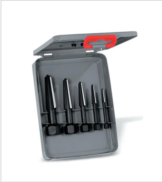
Pour l'extraction sans dommage de vis ou boulons filetés cassés hors des alésages filetés : pré percer la vis à retirer avec l'aléseeur adapté, enfiler l'extracteur dans le trou et dévisser la vis utilisable pour filetage à droite ou à gauche composé d'extracteurs pour vis M5 - M6, M8 - M10, M10 - M12, M12 - M16 et M16 - M20 dimensions : 1 - 2 - 3 - 4 - 5 mm.
