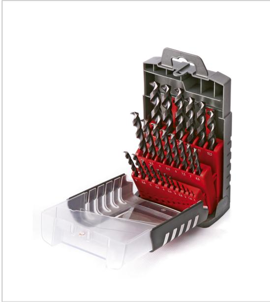
Applications : acier, inox, zamac, bronze, graphite affûtage : pointe en croix angle d'hélice/angle de pointe : 35°/135° tolérance : H8 goujure : type S (meilleure évacuation des copeaux) revêtement : multi-couches (barrière thermique).
