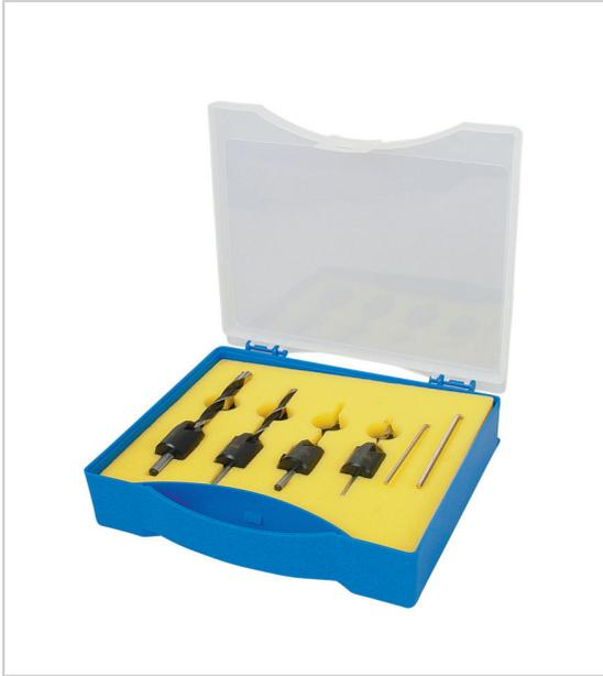
Coffret plastique comprenant 4 fraises sans queue à 90° pour tête de vis en HSS de diamètre 3, 4, 5, et 6 mm avec les forets bois correspondants permet de fraiser en une seule passe l'emplacement de la tête de vis en utilisant le fraiseur à l'envers, il fait office de butée de perçage vitesse de rotation : 1500-3000 tr/min.
