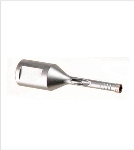
Pour le perçage des carrelages les plus dures (jusqu'à classe 5) : grès céram, terre cuite, faïence, marbre tête segment diamant brasée garantissant un trou rond, propre et sans éclat même à haute température gorge d'extraction de la carotte attachement M14 pour une adaptation directement sur meuleuse pour une utilisation sur perceuse, utiliser l'adaptateur 6 pans/M14.
