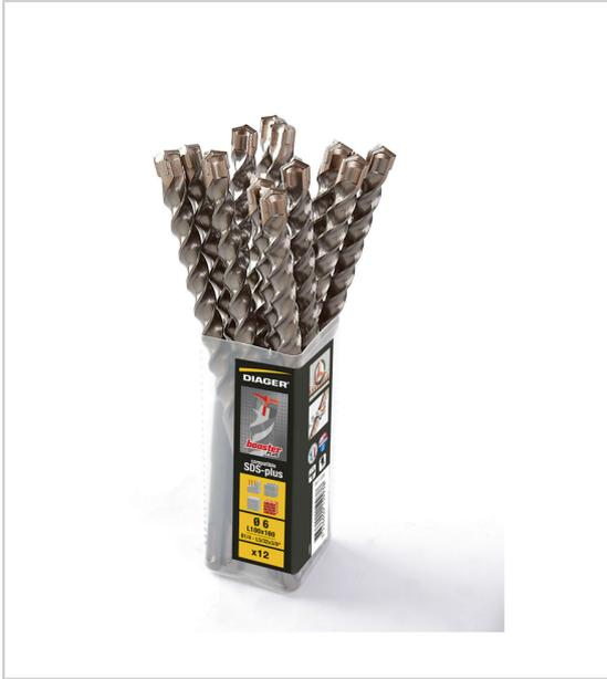
Applications : béton, béton armé, pierre, granit, brique pleine plaquette carbure monobloc avec pointe auto-centrante angle de plaquette 150°technologie 3 taillants hélicedouble taillage demi-ronde et carrée boîte de 12 forets identiques.
