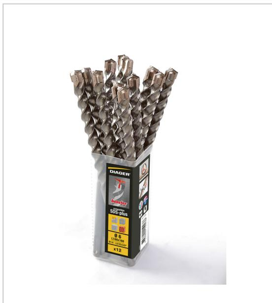
Applications : béton, béton armé, pierre, granit, brique pleine plaquette carbure monobloc avec pointe auto-centrante angle de plaquette 150°technologie 3 taillants hélicedouble taillage demi-ronde et carrée boîte de 25 forets identiques.
