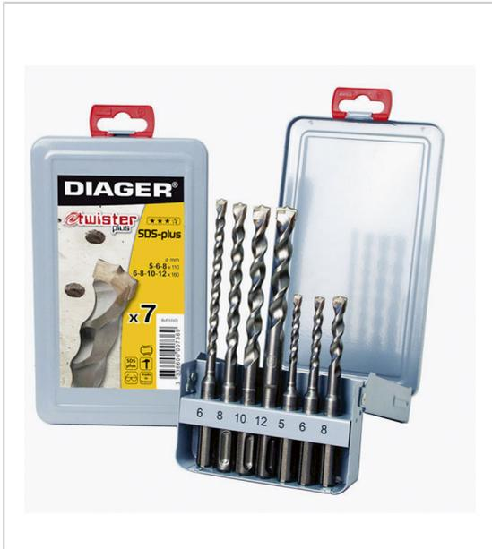
Applications : béton, pierre, parpaing, brique pleine plaque carbure 3 points pointe de centrage géométrie "Z" hélice à double taillage demi ronde et carrée pour une meilleure évacuation des poussières composition : Ø 5-6-8 mm L110 mm, Ø 6-8-10-12 mm L160 mm conditionnement : coffret métal.
