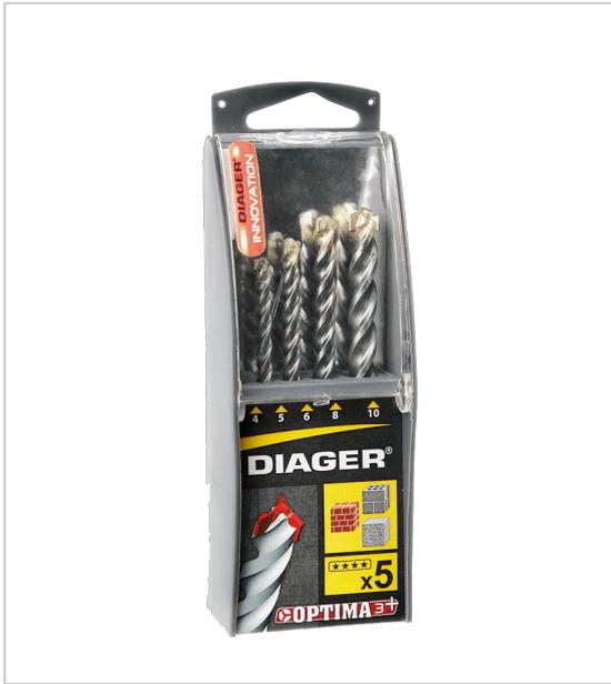
Applications : béton, parpaing, brique, pierre, granit, siporex plaquette carbure monobloc à affûtage positif hélice : 3 gorges d'évacuation taillants 3 arêtes de coupe fractionnées pointe de centrage à 130° livré en coffret plastique.
