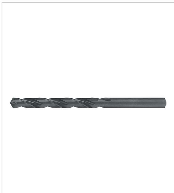
Très appropriée : aciers alliés, non alliés ou faiblement alliés appropriée pour : fontes, aluminium, cuivre et leurs alliages, duroplastiques et thermoplastiques matière de l'outil : HSS surface vaporisée affutage en croix à partir du 1 mm angle de pointe : 118° type d'hélice : N coupe à droite tolérance : h8 vendu en blister (du 1 au 4 mm : prix du blister de 2).
