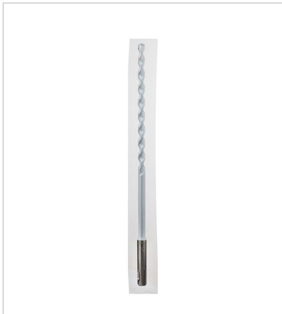
Applications : parpaing, hourdis, bloc de béton creux, brique creuse plaquette carbure positive avec mouche de centrage angle de plaquette 130° hélice progressive courte réducteur de frappe permettant de ne pas endommager les parois du parpaing.
