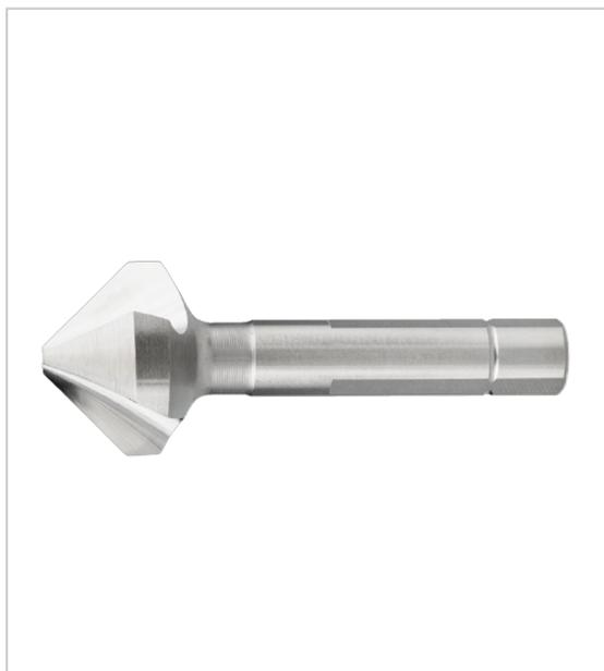
Très approprié pour aciers, inox et fontes Approprié pour aluminium, cuivre et leurs alliages, plastiques Matière de l'outil : HSS-E (5% de cobalt) Surface non revêtue Queue cylindrique avec 3 méplats Angle de chanfreinage : 90° Coupe à droite Pas variable Tolérance : h9.
