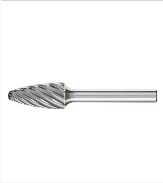
Applications : acier inoxydable, métaux non ferreux, titane pour fraisage, égalisation, ébavurage, usinage des surfaces et des cordons de soudure fraise sur tige en forme d'ogive à bout arrondi selon DIN 8032 diminution des vibrations et du bruit.
