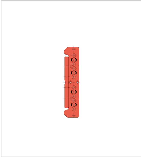
Gabarit de perçage dormant pour palier de compas et palier d'angle K 6/130
