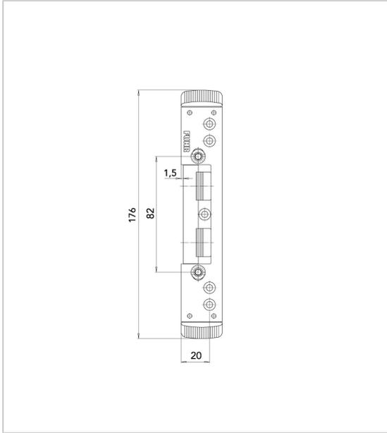
Gâche anti-dégondage en Zamak, à utiliser en combinaison avec le goujon anti-dégondage.
