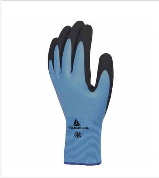
Intérieur : 100% acrylique jauge 10. Extérieur : 100% polyamide jauge 15 main toute enduite latex seconde enduction mousse de latex sur paume et bout des doigts très bonne résistance au froid et à l'humidité idéal en environnements froid allant jusqu'à -30°C.
