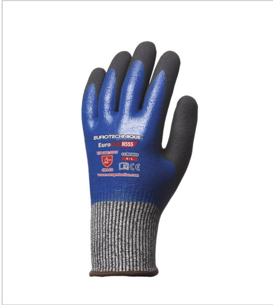
Tricot gris HPPE et fibre de verre, double enduction (nitrile bleu lisse sur la totalité de la main + nitrile noir effet "grainé" sur la paume) poignet élastiqué jauge 13 idéal manipulation de pièces coupantes en milieu huileux.
