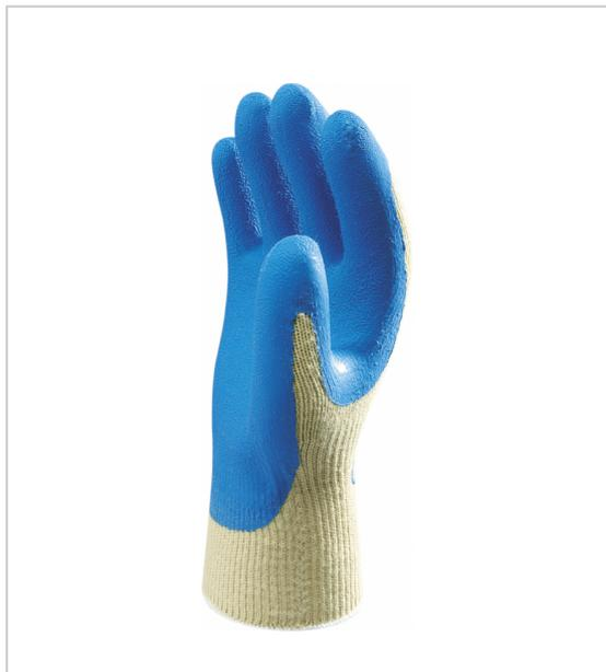
Tricot fibres TAEKI (30%) / ARAMIDE (70%), jauge 10, enduction latex haute qualité sur la paume et retour bouts des doigts dos de la main et des doigts aéré poignet élastiqué de 8cm, surfilé de couleur par taille très bonne résistance à la coupure et antidérapants forme anatomique et excellente dextérité.
