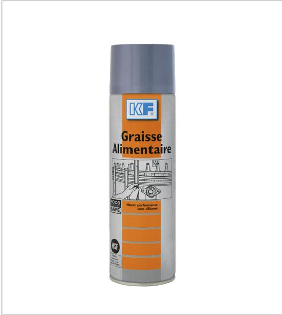
Graisse blanche à base d'un savon épaississant inorganique et d'une huile minérale extrêmement raffinée utilisation recommandée en industrie alimentaire lorsqu'un contact accidentel avec les aliments est possible pour lubrifier des charnières, engrenages, joints, robinetterie résiste à l'eau et à la vapeur bonnes propriétés anti-usure et anti-corrosion utilisable de - 20°C à + 140°C (180°C en pointe).
