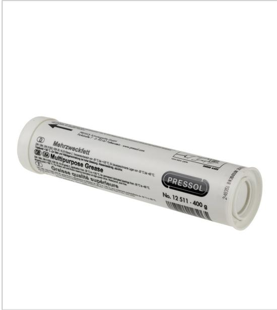
Pour graissage de paliers et roulements, à forte charge résistante à l'eau, sans acide grade NLGI : 2 température d'utilisation : de -30 à +120° C, pour des roulements graissés en continu de -30 °C à +80 °C pointe de goutte : > 190 °C.
