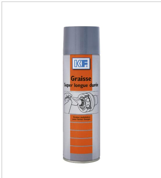
Graisse noire à base de savon de lithium et d'huile minérale avec du bisulfure de molybdène (MoS2) pour la lubrification des organes qui subissent de fortes charges et de faibles vitesses : engrenages, cardans, articulations des escalators, tapis roulants... résiste aux pressions élevées, chocs, à l'eau et à la corrosion utilisable de - 30°C à + 130°C.
