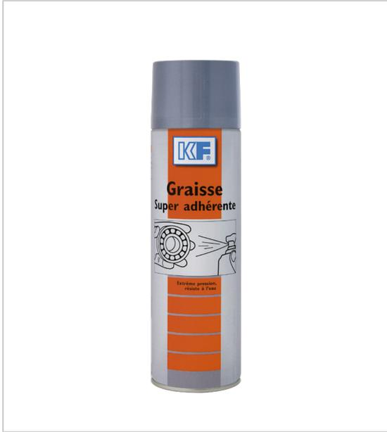
Graisse verte (aérosol) à base de savon de lithium et d'huile minérale excellente adhérence résistante à l'eau contient des additifs antioxydants et extrêmes pressions haut pouvoir lubrifiant pour des utilisations dans des conditions sévères (pluies, froid, échauffements) et en extrême pression pour roulements, galets, paliers, câbles... utilisable de - 30°C à + 140°C.
