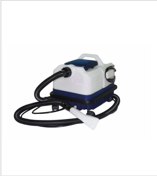
Moteur By-Pass à refroidissement indépendant et filtre inox anti-mousse système d'arrêt cuve pleine par flotteur intégré pompe d'injection Haute Pression 4 bars 4 roulettes embouchure fauteuil en PE de 80 mm spéciale intérieurs de véhicules buse d'injection externe permettant un travail de nettoyage/aspiration en simultané flexible d'aspiration de 3m à utiliser avec le détergent TOP WASH SV1.
