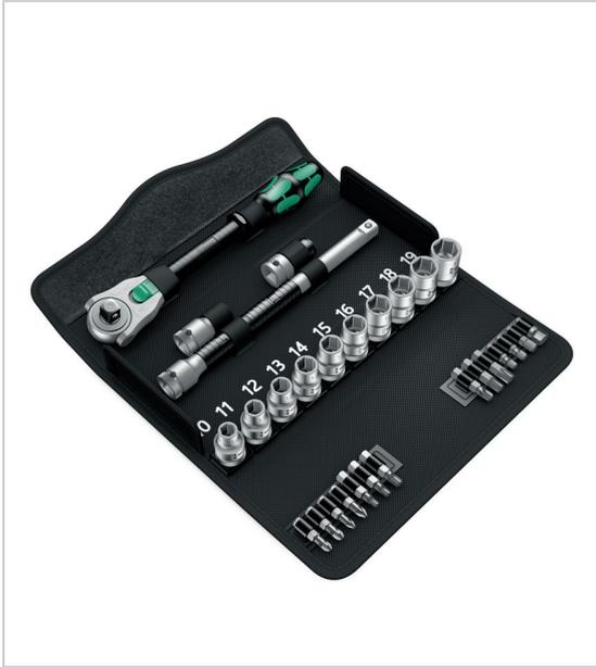
Composition : - 1 cliquet Zyklop Speed à emmanchement 1/2" (8000 C : 1/2"x277,0 1) - 10 douilles Zyklop 10 à 19 x 37 mm (8790 HMC) - 1 rallonge Zyklop (longue) avec douille à rotation rapide 250 mm (8794 LC) - 1 rallonge "Wobble" 52 mm (8794 C) - 1 adaptateur avec mandrin à serrage rapide 5/16"x1/2"x50,0 (8784 C2) - 14 embouts PH : PH 2 - 3 x 32 mm PZ : PZ 2 - 3 x 32 mm TORX® : 20-25-30-40-45-50 35 mm Z : 5-6-8-10 x 30 mm
