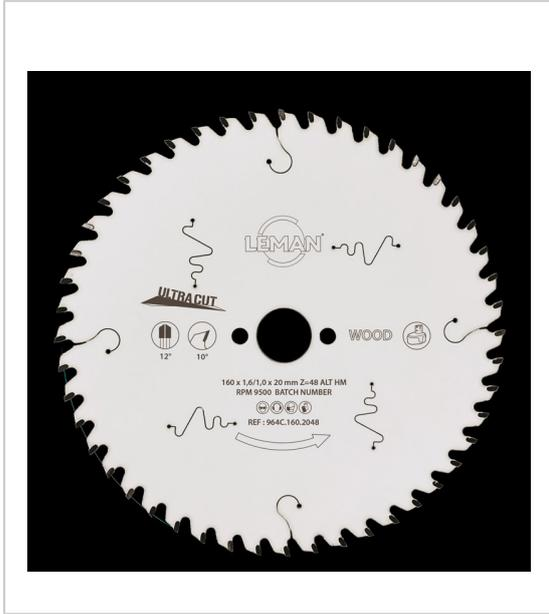
Pour machines portatives et à onglets sur batterie lame en carbure de tungstène (plus résistant que l'acier) Affûtage spécifique ULTRA CUT pour une meilleure longévité de l'outil Talon anti-recul limiteur de passe Epaisseur fine permettant de réduire l'effort de coupe Autonomie de batterie optimisée Réduction des chutes de matière Découpes laser du corps réduisant les vibrations et l'impact sonore Idéal pour bois massif, bois latté, bois contre-plaqué et MDF.
