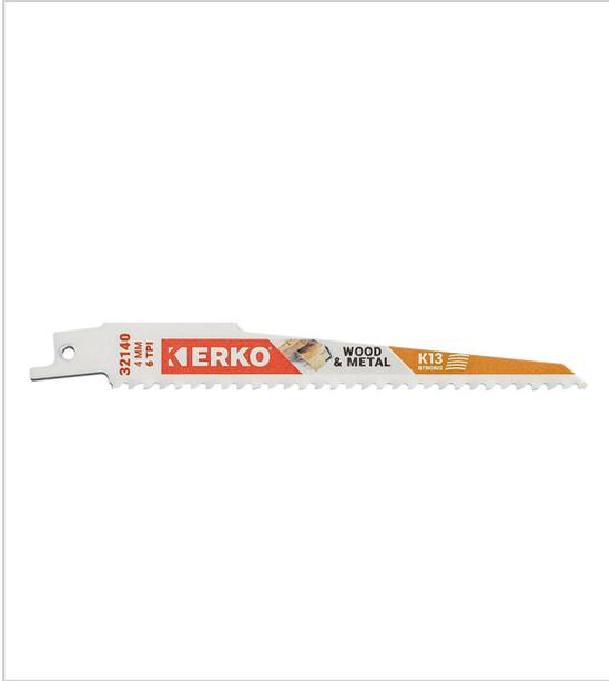
Bimétal : - HSS M42 8% cobalt, très dur et résistant à l'échauffement pour les dents - acier ressort très endurant pour le corps de la lame denture 6 TPI (pas de 4 mm) idéale pour le bois, rapide et résistante avoyage spécial pour avancer constamment, même dans les grosses sections forme de dent "PROFIL-K" adaptée aux chocs dans les clous, les vis, les ferrures série K13 strong : pour le débit de bois, pour tous les travaux de menuiserie, de déposes des fenêtres étui de 5 lames.
