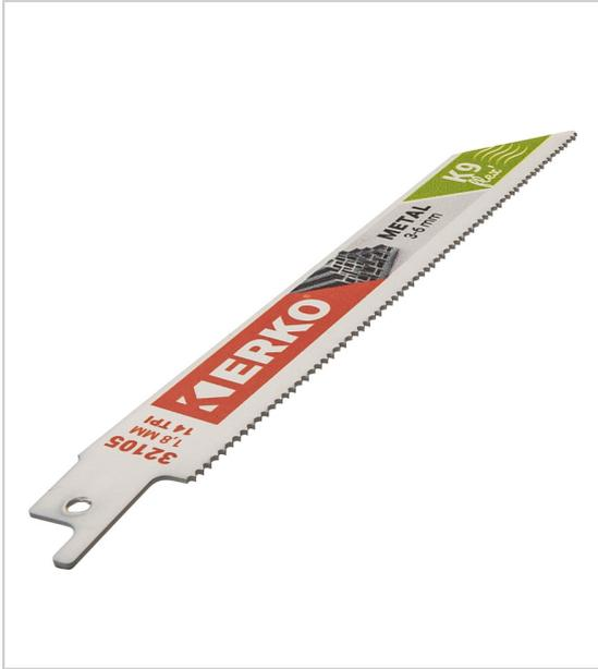
Technologie bimétal, l'association de 2 aciers :- un HSS M42 avec 8% de Cobalt très dur et résistant à l'échauffement pour les dents- un acier ressort très endurant pour le corps de la lame Denture 18 TPI (pas de 1,4 mm) fine pour éviter les chocs contre les parois des tubes Série K9 pour des copeaux très fins et une réduction des vibrations Etui de 5 lames.
