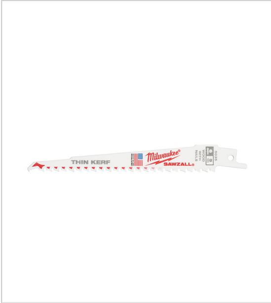
Construction Bi-métal flexible pour supprimer les risques de rupture. FANG TIP: Pour les coupes en plein bois et l'accès aux espaces réduits. NAIL GUARD: Meilleure résistance aux rebonds pour une durée de vie accrue. Idéales pour le bois avec des vis ou des boulons. Géométrie agressive des dents pour des coupes encore plus rapides. Design incliné pour une coupe plongeante et atteignant des zones restreintes.
