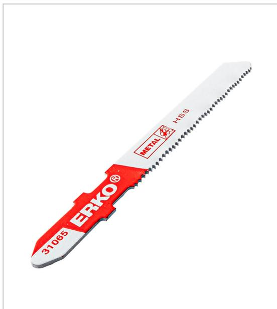
Technologie HSS pour la tôle en acier, l'aluminium Denture 21 TPI (pas de 1,2 mm) : 1 à 3 mm d'épaisseur Étui de 5 lames.
