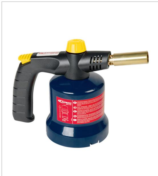
Énergie : gaz butane volant d'ouverture et de réglage du débit de gaz et de la flamme cloche en acier protégeant la cartouche plaque de verrouillage type de flamme : dard capacité de brasage sur des tubes en cuivre CuPh / Étain 40% / CuPh 30% Ag/Sn 97% Cu 3% : Ø 14 / 14 / 16 / 50 mm.
