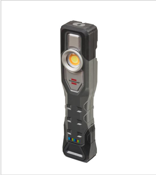
Conçue pour la concordance et la vérification des couleurs de peinture, détection des défauts de peinture 3 températures de couleur : 2700K - 4500K - 6500K pour évaluer une surface dispose de la fonction de variation de l'intensité lumineuse en continu de 10% à 100% indice de protection : IP54 intensité lumineuse : 900 lm (en façade) + 200 lm (en frontal) ampoule LED fonctionnement : batterie (3,7V/5,0Ah).
