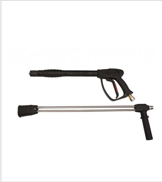
Raccord d'entrée F3/8" rotatif, raccorde de sortie 1/4" NPT F, débit de 40 l/mn, température maximale 150°C.
