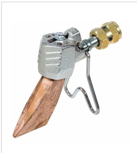
Lance pour fers de couvreur avec panne compacte, légère et silencieuse montée en température très rapide. Importante économie d'énergie corps en fonte aciérée avec traitement anti-corrosion adaptée au travail du zinc, du cuivre, de l'inox, du zinc pré-patiné et du plomb pied 2 positions à effet ressort sa flamme, du type de celle des lances cercoflam est enveloppante.
