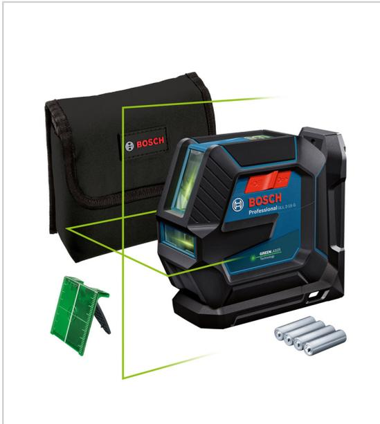
Lignes laser horizontales et verticales mise à niveau automatique jusqu'à 'b1 4° filetage du trépied: 1/4", 5/8" protection IP64 livré avec support universel LB 10, platine de mesure laser, poche et 4 piles 1,5 V LR6.
