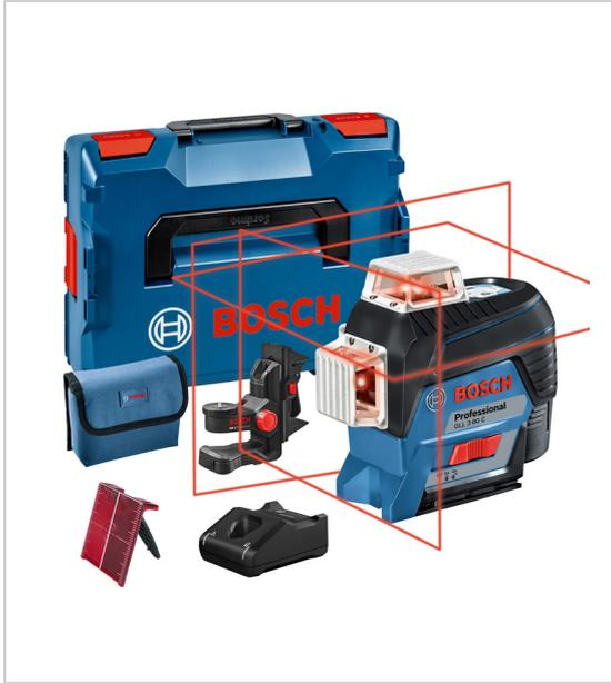
3 lignes laser sur 360° permettant d'effectuer simultanément des mise à niveau horizontales et verticales fonction de surveillance CAL Guard très précise possibilité de commande à distance depuis un smartphone avec l'application mobile basée sur Bluetooth mise à niveau automatique 'b14° en 4 s protection IP 54 classe laser 2 filetage du trépied : 1/4", 5/8" livré dans un coffret de transport L-BOXX avec batterie 12V 2Ah, chargeur rapide, platine de mesure laser, housse.
