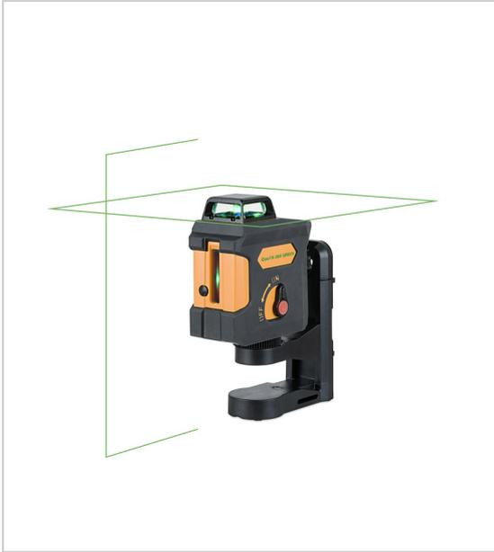
Laser 2 lignes, 1 horizontale 360° et 1 verticale blocage du compensateur pour utilisation en manuel support multi-fonctions hauteur réglable aimant puissant sur le dos du support filetage 1/4" et 5/8" fourni avec : support multi-fonctions, 4 x AA piles alcalines et sacoche rembourrée.
