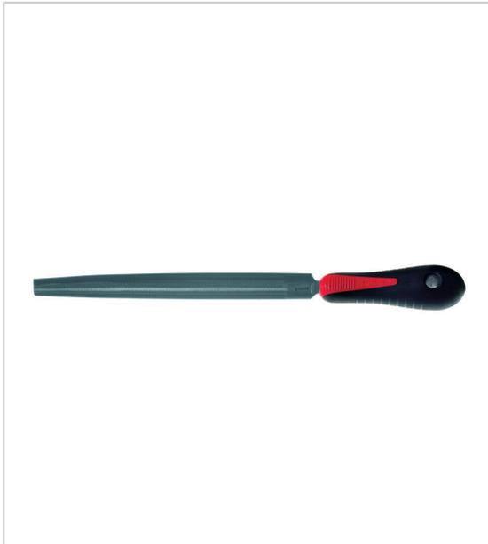
Grande longévité de la coupe grâce à l'acier fortement chargé en carbone (1,3 à 1,4 %) acier allié au chrome pour obtenir un mordant puissant dureté de 65 à 62 HRC manche bi-matière : polypropylène (résistance et relief permettant de travailler avec précision) et élastomère (souple et confortable - limite la transpiration et l'échauffement de la main).
